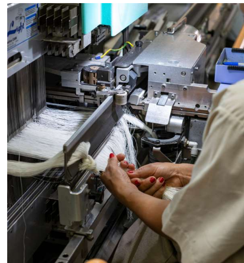
Operaria en remetedora staubli - Salón Driles
