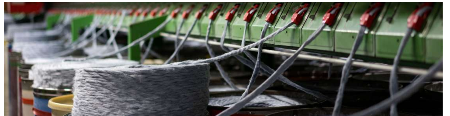
Sistema de hilatura open end, fibra recuperada.
